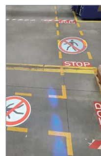
↑ Projektion „Durchgang verboten“ sorgt für klare Zonen und sichere Abläufe
