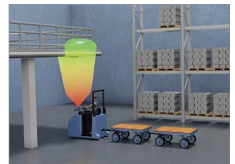
↑ Intelligente Radartechnik für sichere Rückfahr- und Unterfahrprozesse
