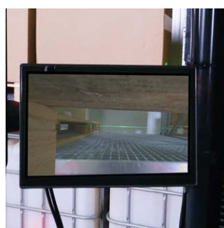
↑ Gabelkamera im Livebild – exakte Ausrichtung bis ins Palettenfach
